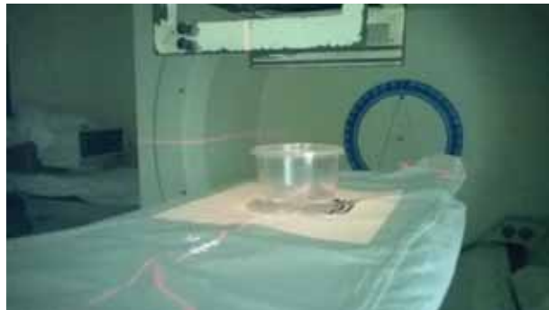
Figura 6: Alinhamento do campo para irradiação das pupas.
