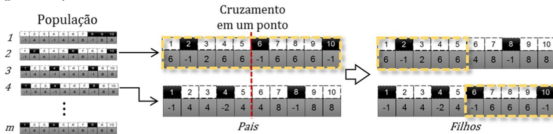
Figura 5 - Operador de cruzamento
