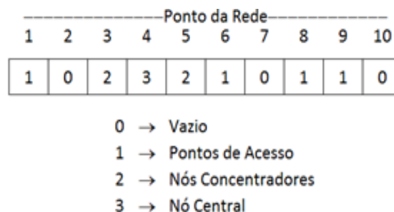
Figura 4: Exemplo de cromossomo com limite de níveis igual a 3.
