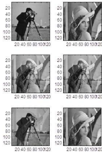
Figura 5. Recuperação de imagens usando abordagem não linear para uma imagem com 128x128 pixels. Topo: fontes; Meio: as misturas; Inferior: imagem recuperada.
