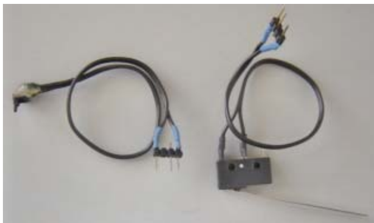
Figura 40 - Sensores de toque utilizando micro chaves
