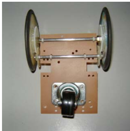
Figura 52 - Montagem das rodas
